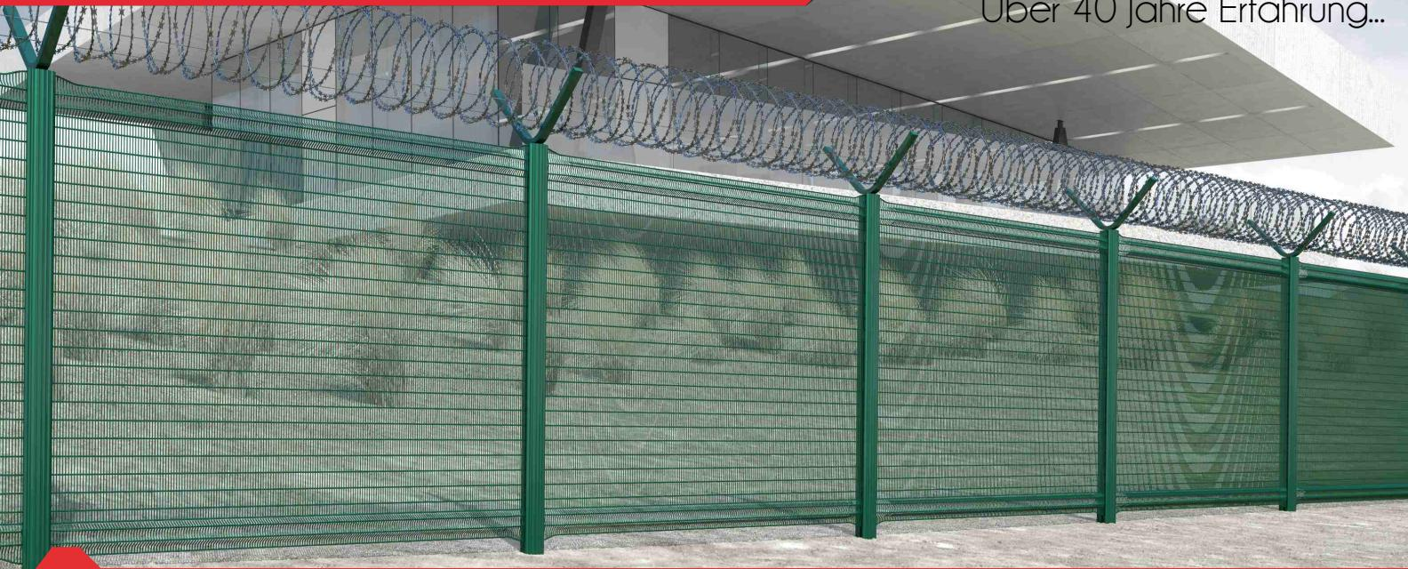
Der SecuriFix K-DAG Aluminiumpfosten (123x120) ist für Anwendungen im Hochsicherheitsbereich speziell entwickelt worden. Der Aluminium-Typ wird besonders für hochkorrosive Anwendungen empfohlen. Die Stabmatten werden von der Rückseite am Pfosten befestigt, wodurch ein Durchbruch von der Vorderseite verhindert wird. Aufgrund dieser Eigenschaft wird der Pfosten SecuriFix K-Dag genannt. Es gibt zwei Möglichkeiten der Montage: mit Flacheisen oder Metallclips mit Bolzen.
